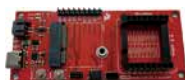
④ SparkFun MikroMod Mikro Bus Carrier Board (①~③と接続する ドーターボード)
